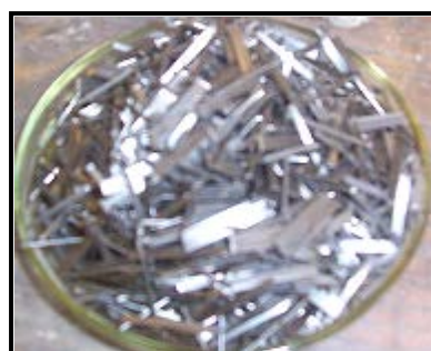
Photo 3 : Fibres métalliques Dramix
